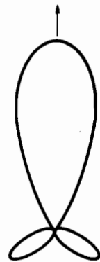
FIG. 4. — Diagramme polaire d'une antenne Yagi très directive comportant des éléments multiples.
